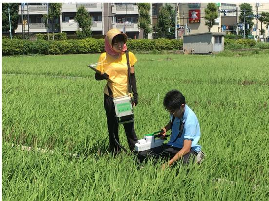
図1：MIC-100を用いた光合成測定の様子
